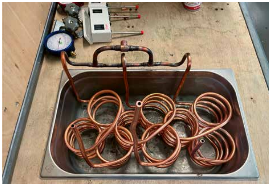
Obr. 4: Takto vypadal výpárník, který se vyráběl z Cu 10 mm trubek.
