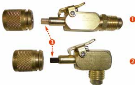
1 přímá a 2 rohová rychlospojka pro hadice se závity ¼" SAE 3 kolík pro odtlačení jádra Schrader-ventilu
