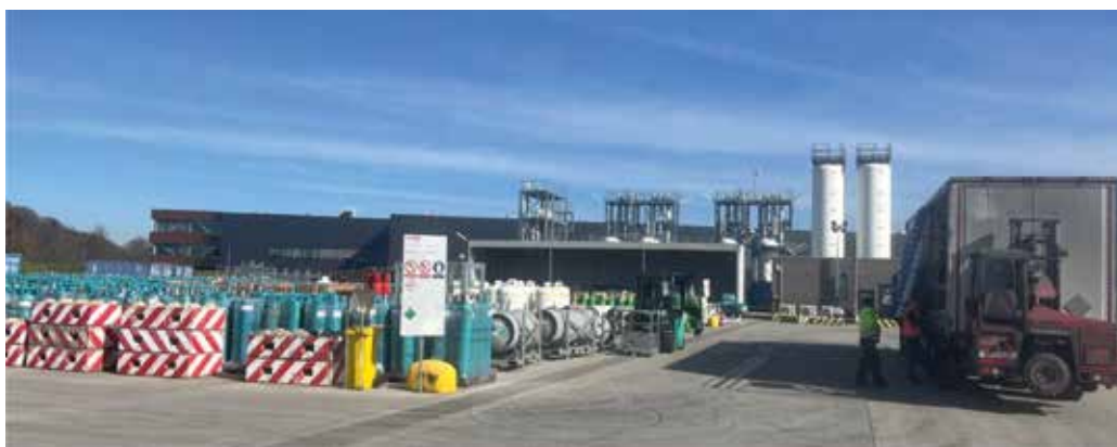
Obr. 3: Daleko větší prostor, než samotná regenerační technologie zabírá sklad lahví a ISO tanků na chladiva, který musela firma už několikrát rozšiřovat.
