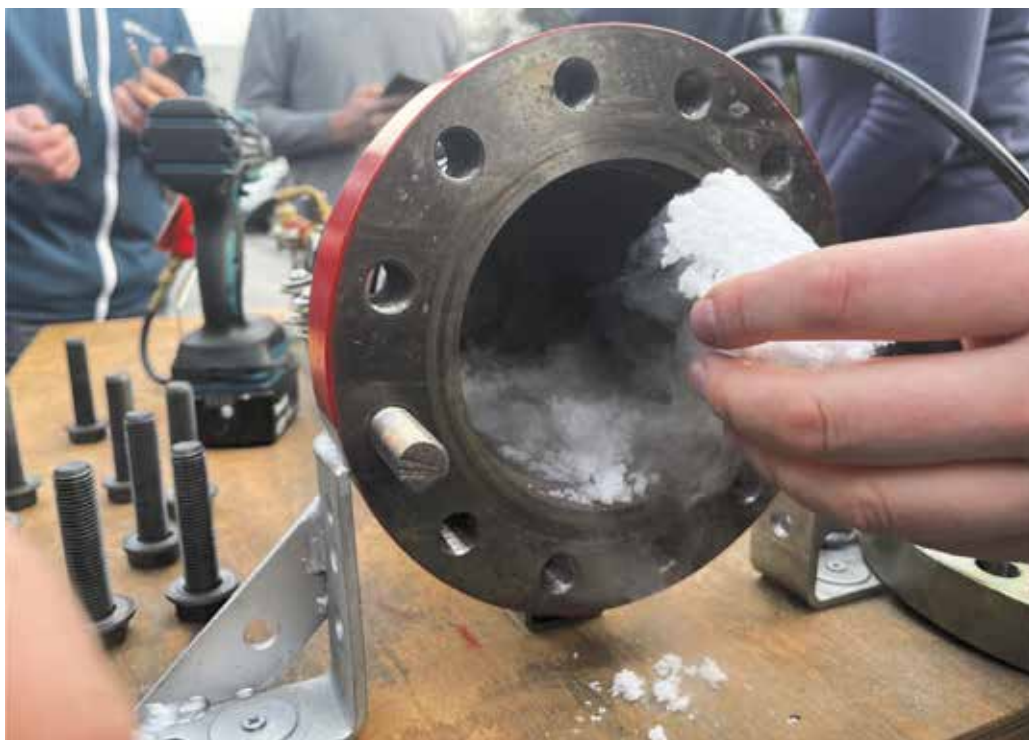
Obr. 8: toto je speciálně upravené potrubí, ve kterém lze demonstrovat jak při nesprávné manipulaci s \text{CO}_2 může vzniknout suchý led, který může ucpat potrubí nebo hadice a způsobit destrukci systému.
