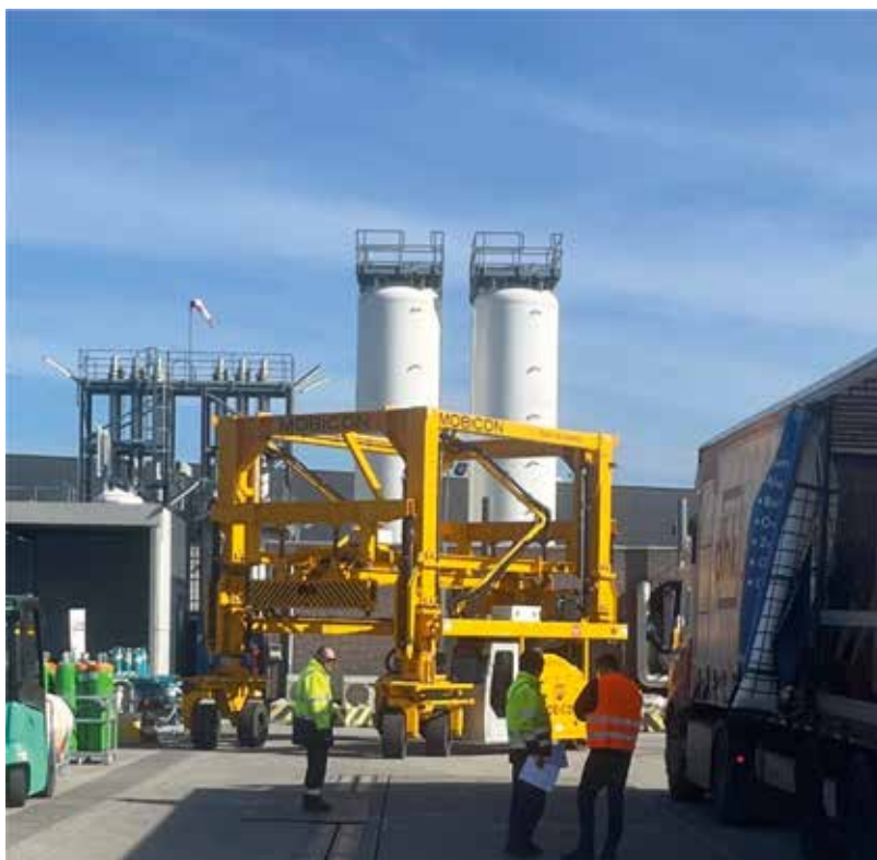
Obr. 4: Pro snazší manipulaci s tanky na chladivo o velikosti kamionového kontejneru je k dispozici speciální jeřáb.
