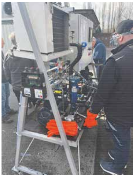
Obr. 9: školicí jednotka s CO 2 , která se při výuce vypouštění a následně plnění chladivem z bezpečnostních důvodů přesune do venkovních prostor.
