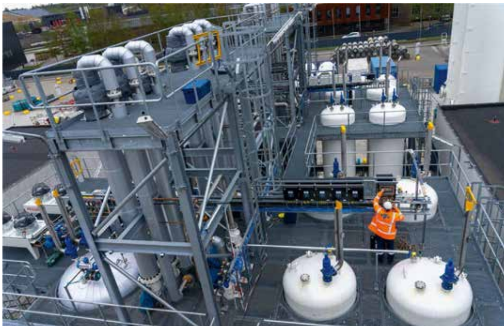
Obr. 2: Destilační technologie A-GAS v Eygelshovenu, kam putuje velké množství znovuzískaných f-plynů z celé EU.
