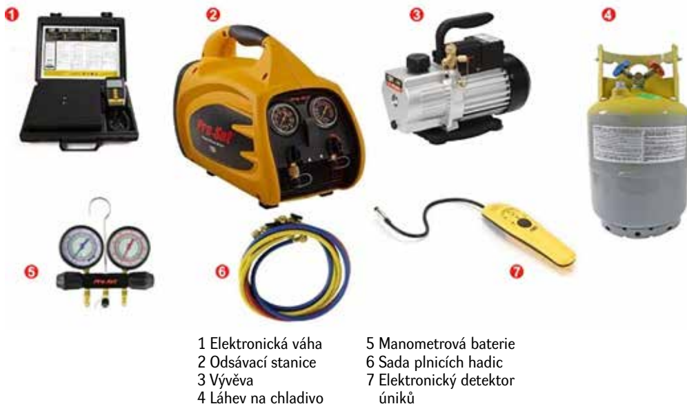
Obr. 3.6 Základní sestava pro odsávání, plnění a vakuování
