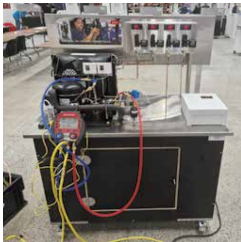
Obr. 4: Na tomto zařízení se hledaly a odstraňovaly závady. Jednotka byla následně naplněna chladivem R290.
