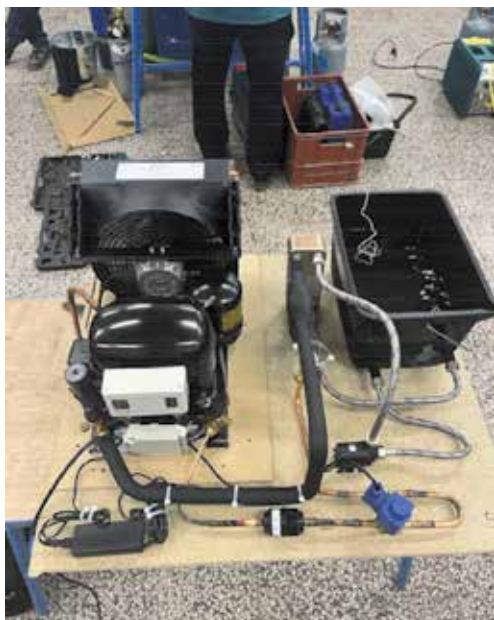
Obr. 4: Zajímavé bylo srovnání finálních řešení konstrukce zařízení. Takto řešil sestavení chladíče kapaliny vítěz soutěže Pavel Kopejtko
