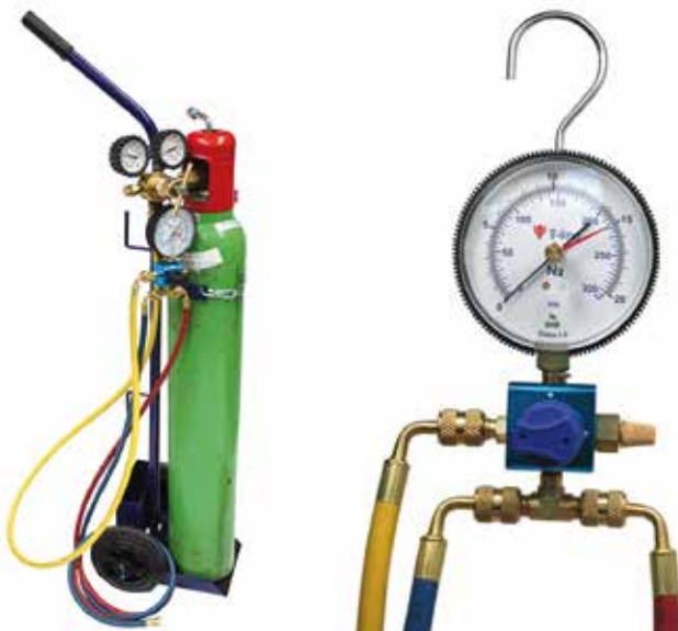
Obr. 2.1 Sestava pro zkoušku přetlakem dusíku a zkušební manometr
